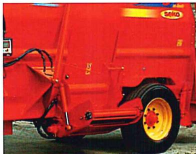
Protezione mediante riparo laterale del nastro trasportatore presente nell'apertura di scarico.
