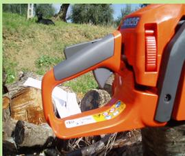
✓ Interruttore di massa per arresto definitivo il cui azionamento sia possibile quando la motosega è tenuta da entrambi le mani e con guanti protettivi
